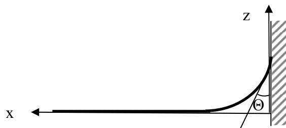
Рисунок 4. Форма поверхности жидкости вблизи вертикальной смачиваемой стенки. \Theta – краевой угол.
