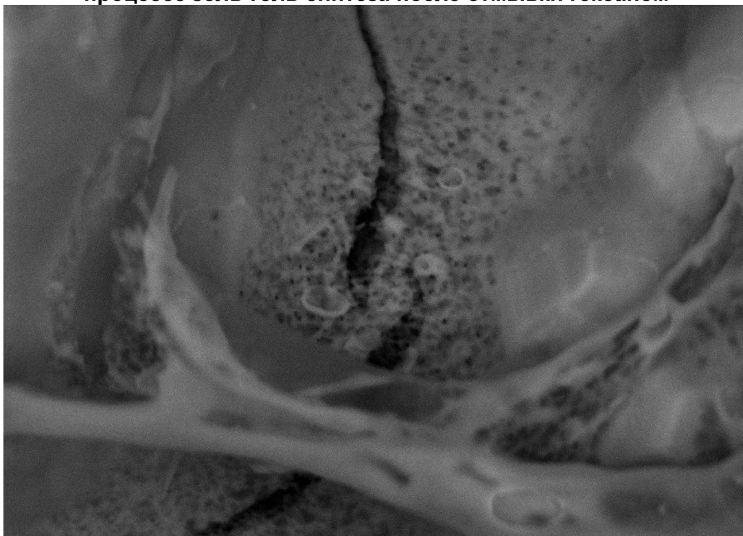
Рис. 16. Трещина между шариками с нанесенной неподвижной фазой DMS-S45 в процессе золь-гель синтеза после отмывки гексаном и обработанные ГМДС
