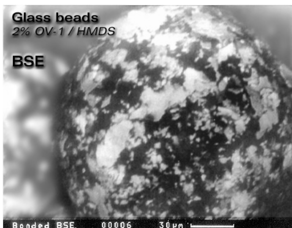
Рис. 7. Стеклянные шарики с нанесенной неподвижной фазой (2% OV-1) обработанные ГМДС
