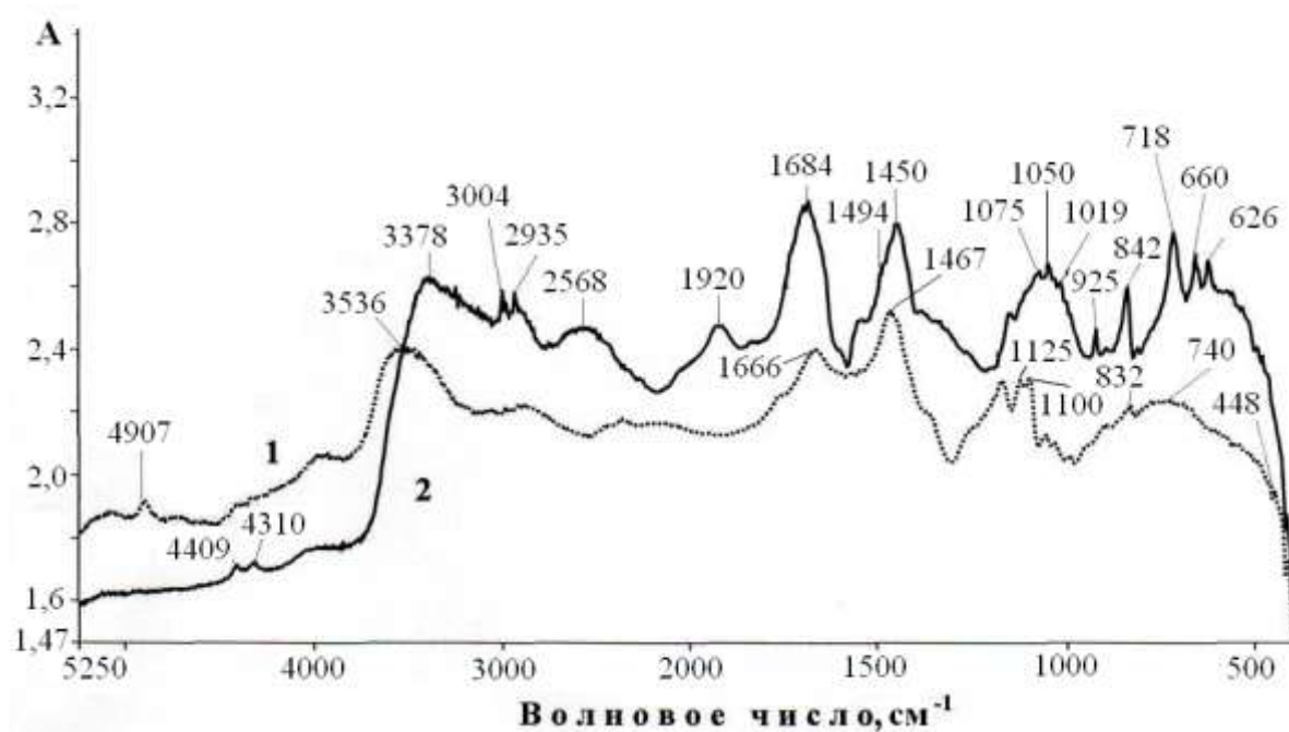
Рис. 10. ИК-спектры диффузного отражения хитозана: 1 – образец 2; 2 – образец 2 с адсорбированными ионами меди.
