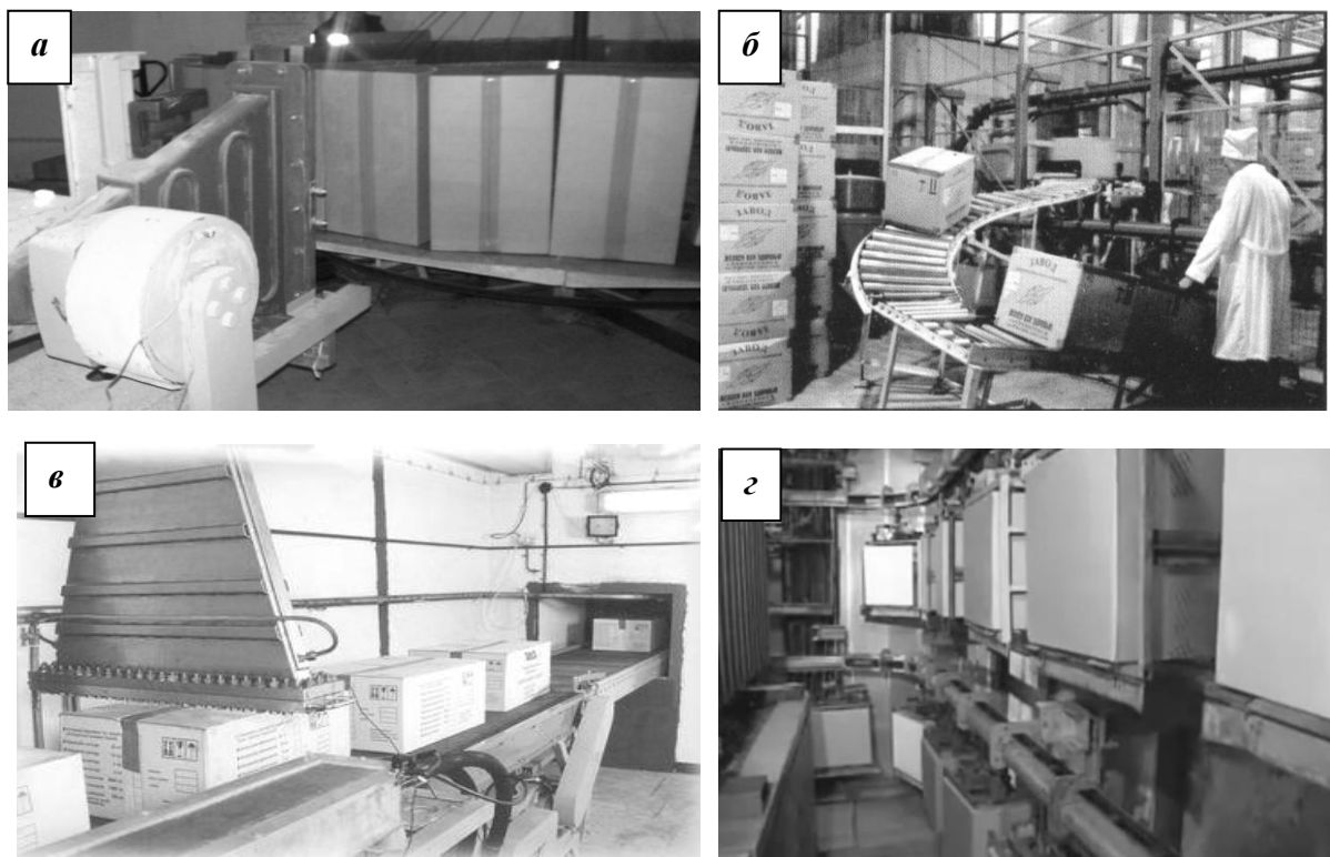
Рис. 21. Электронно-лучевая стерилизация медицинских изделий, лекарств, косметики и радиуризация пищевых продуктов в транспортных картонных коробах. а - ИФХЭ РАН; б - ЗАО "ИНТЕХ", в - ФГУП "Торий"; г - ОАО "МРТИ РАН";
